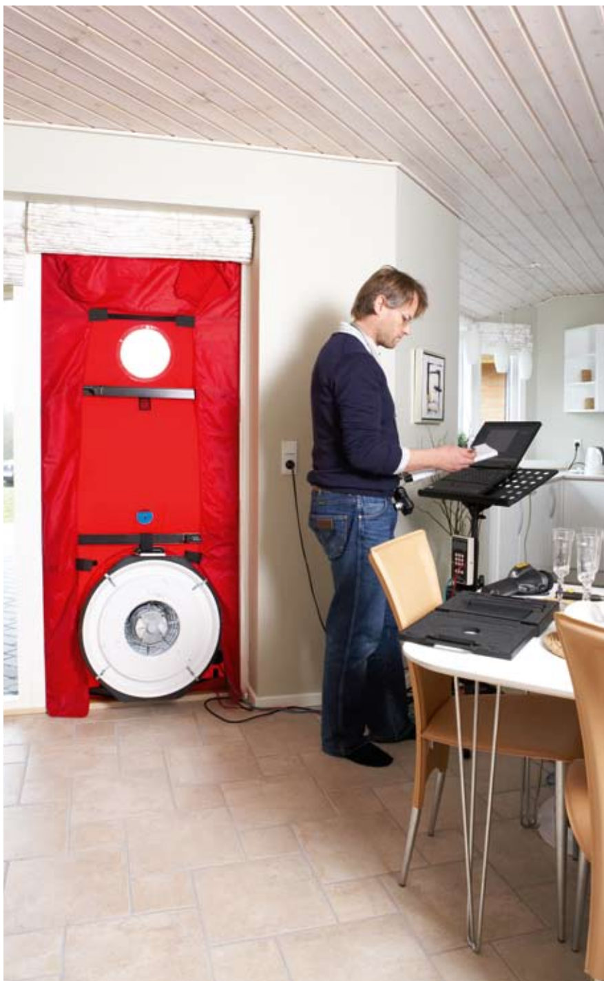
Fig. 240.3. Yderdøren erstattes med en blower door med indbygget ventilator. Ventilatoren, som styres af en pc, kan skabe det nødvendige over- eller undertryk i bygningen.
