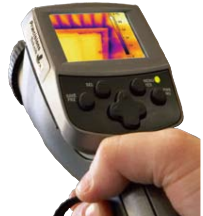
Fig. 240.7. Mørke farver angiver kolde områder og er dermed med til at indikere problemer med lufttætheden. Her mangler der tætning langs rammen ved loftlem.
