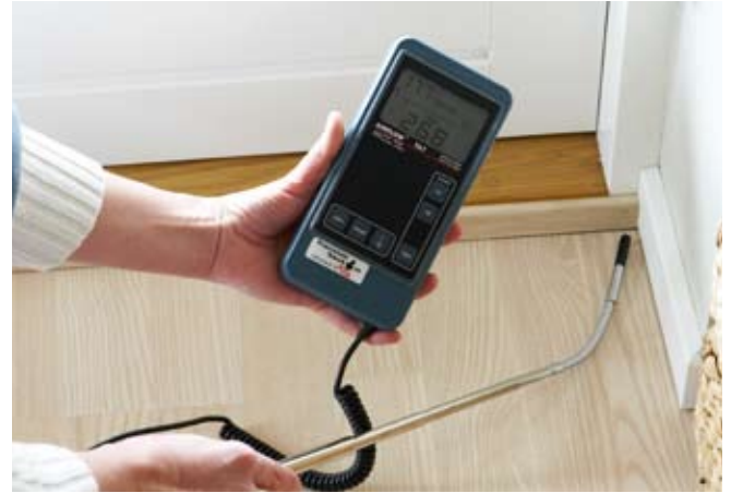
Fig. 240.5. Vindmåleren måler vindhastigheden gennem utætheden og kan dermed indikere områder med utætheder og potentielle trækgener.
