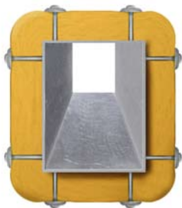
Rektangulære kanaler brandisoleres med 60 mm U Protect Slab 4.0 Alu1
