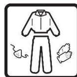
Tildæk udsat hud. Bær ansigtsmaske til engangsbrug ved arbejde i uventilerede rum
